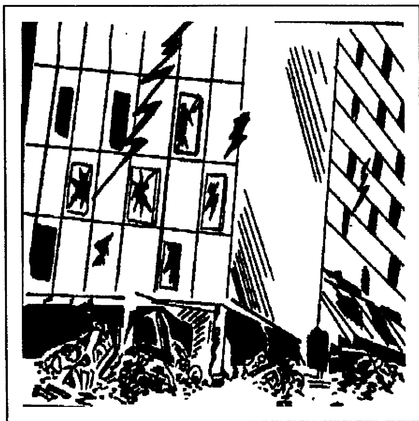
Figura 15 Colapso de un edificio esquinero, terremoto de San Salvador 1986.
