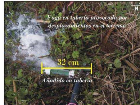
FIGURA 5.16. DAÑOS GENERADOS POR GRIETAS ACTIVAS DE DESLIZAMIENTO SOBRE LA TUBERÍA DE AGUA POTABLE, SECTOR DE BARRIO SAN JUANILLO. COORDENADAS 215806N-583409E.
