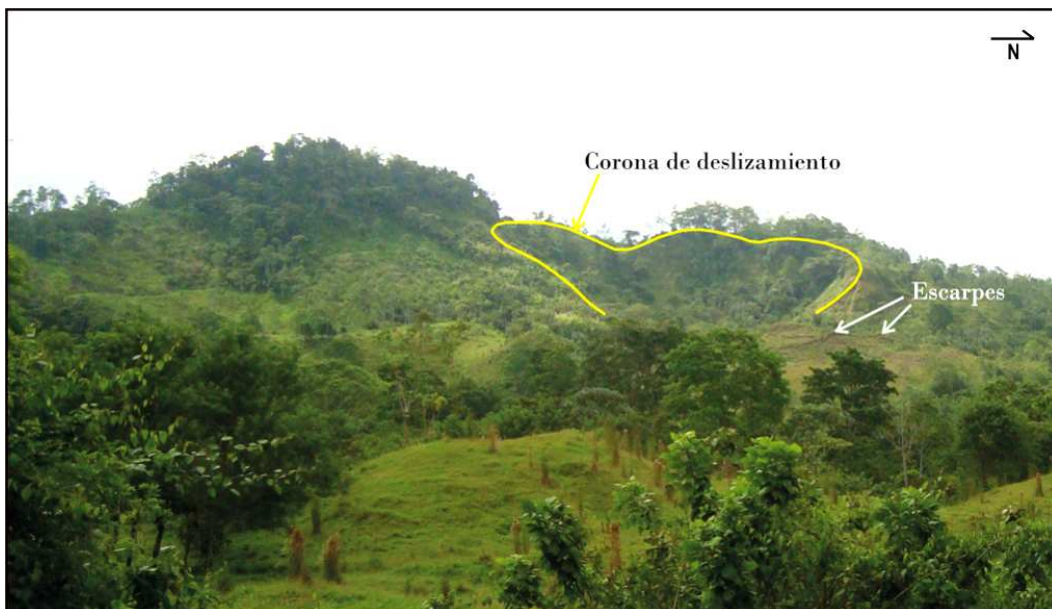
FIGURA 3.56. CORONA DE DESLIZAMIENTO AL ESTE DEL ESCARPE LONGITUDINAL, CON FORMACIÓN DE ESCARPES ESCALONADOS EN LA BASE DEL DESLIZAMIENTO. ESTA IMAGEN SE UBICA EN EL LÍMITE OESTE DEL SUB-BLOQUE SAN PABLO. COORDENADAS: 214634 N / 583499 E
