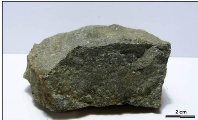
**Figura 5:** Conglomerados brechosos polimícticos. Muestra tomada en las coordenadas 518673/209500
