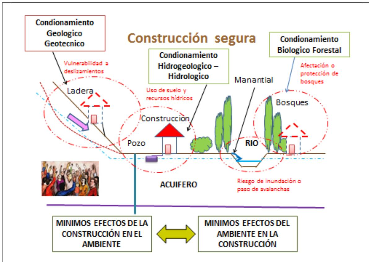
**Fig. 12.3** Concepto básico de "Construcción Segura", cuya finalidad es que todas las construcciones cuenten con los elementos de seguridad ambiental básicos, de manera tal que se generen los mínimos efectos de la construcción al ambiente y los mínimos efectos del ambiente en la construcción.
