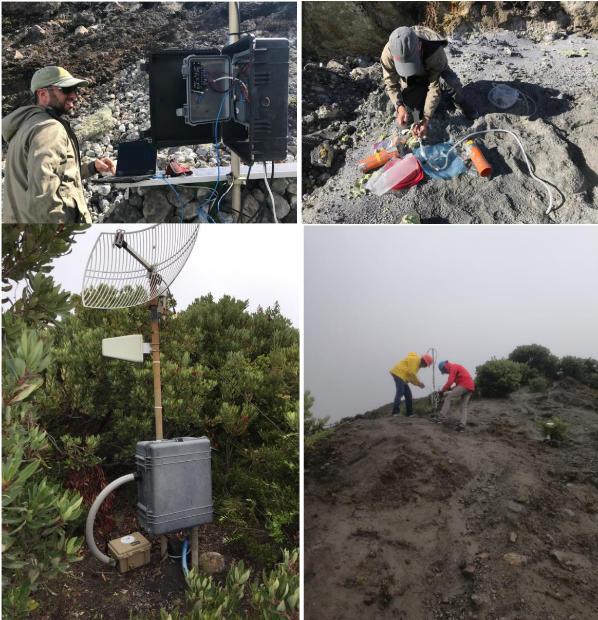
Fig. xx. Ejemplo de algunos de los equipos y técnicas de vigilancia volcánica en el Irazú. A) Estación Multigas para medir \text{CO}_2 y \text{H}_2\text{S} . B) Muestreo de desgasificación difusa, C) Estación para muestrear \text{SO}_2 y lluvia, D) Estación sísmica con infrasonido. Fotografías cortesía OVSICORI y Laboratorio de Química de la Atmósfera, ambos de la UNA.
