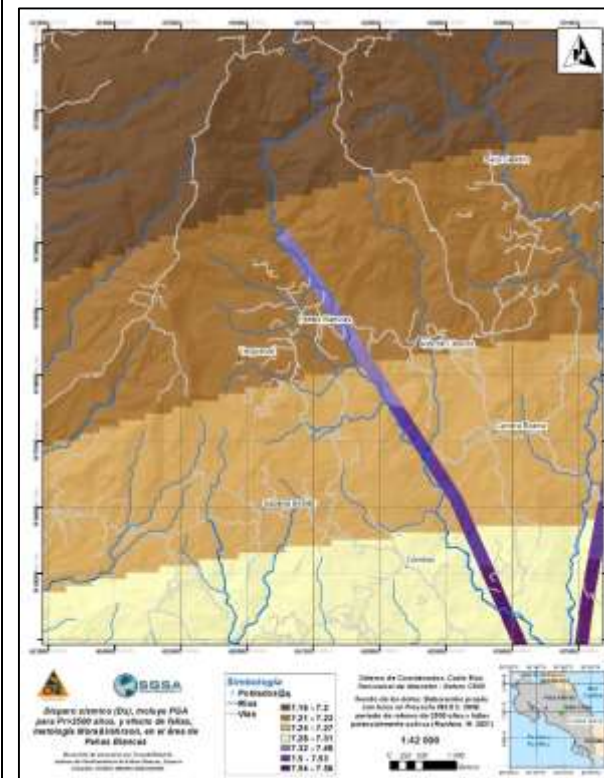
Figura A3-24. Factor de disparo por sismicidad (Ds), para Pr=2500 años, método Mora&Vahrson
