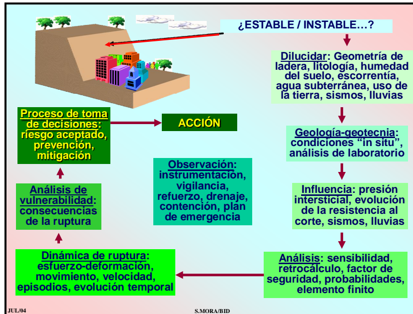
Figura 10 Estabilidad o inestabilidad de un talud
