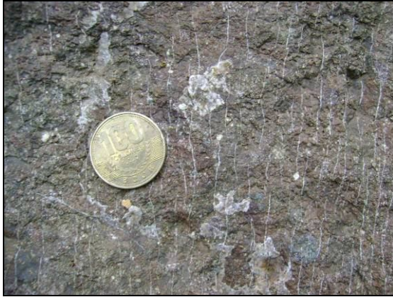
Fotografía 5: Múltiples vetillas milimétricas de calcita en lavas originadas por tectónica.
