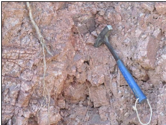
Fotografía 7: Lavas rojizas con evidente afectación por movimiento en masa.
