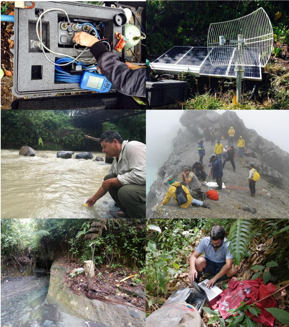
Fig. 7.3: Ejemplo de algunos de los equipos y técnicas de vigilancia volcánica en el Rincón de la Vieja. A y B) Arriba, estación sismológica y transmisión de los datos. C y D) Muestreo de aguas y barros de lahares (izquierda) y del lago hiperácido (derecha), E y F) Equipo de estudiar lahares en la quebrada Zanjonuda.
